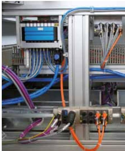
IO-Link-Sensorhub eine 3-adrige IO-Link-Leitung. Kabelgewicht und Kabelvolumen stehen in einem Verhältnis von 8:1. Darüber hinaus verursacht der passive Verteiler einen deutlich höheren Aufwand (geschätzt sechsfach) in CAD Design, Dokumentation (Belegungspläne) und an Installationszeit im Feld.
