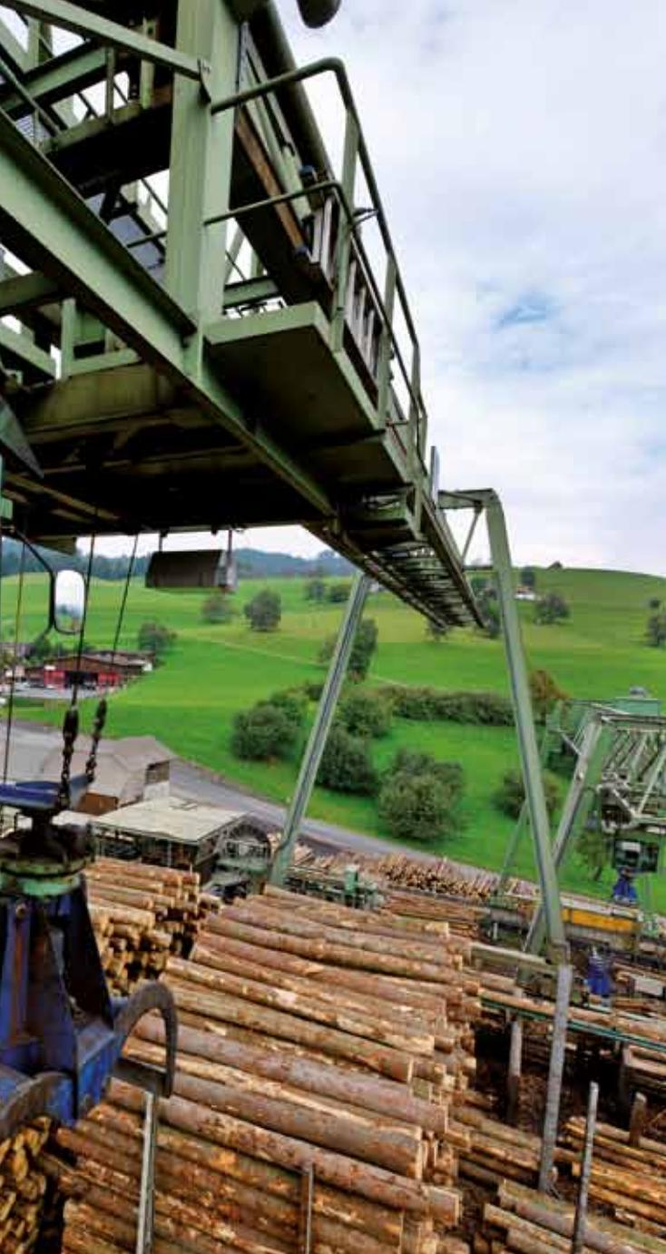
ge vermag bis zu 10 Tonnen auf einmal zu heben. Der Portalkran weist eine Metern auf.
