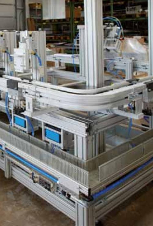
Mehr als 500 Einzelverdrahtungen wurden in dieser Montageanlage, in der vollautomatisch Ventile für die weiße Ware montiert werden, eingespart.
