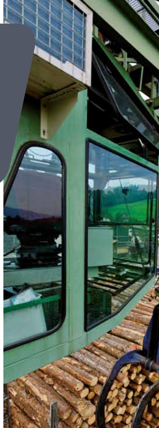
**Die Laufkatze mit der Bedienerkabine und der Greifzange Breite und somit einen Fahrweg der Laufkatze von 150**
