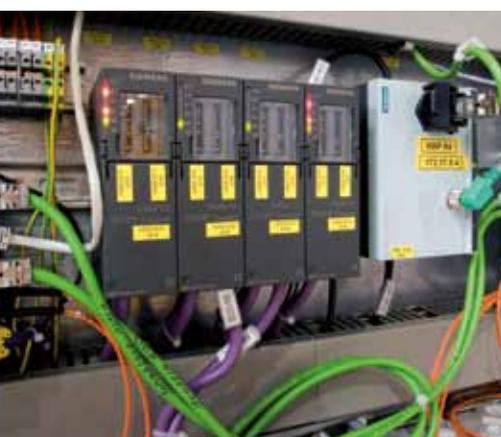
**Unter der Haube: Die Steuerung der fahrerlosen Transportsysteme basiert auf einer Simatic S7-300 mit einem IWLAN Access Point Scalance W7471RR zur Kommunikation mit dem Fertigungsleitner.**
