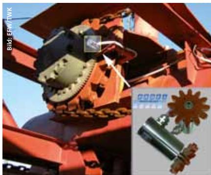
Winkelcodierer mit Ritzel erfassen die Position des Kettenrades zum Antrieb der Trichtervertstellung beim Hafenaufbau in 20 m Meerestiefe.
