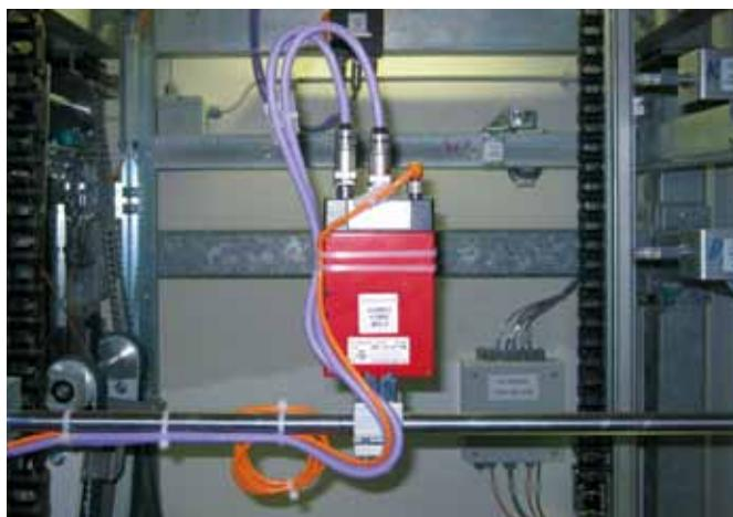
Das Innenleben des Vertikalförderers zeigt hochdynamische Antriebs-elemente und zuverlässige Leuze electronic Sensoren am PROFIBUS.
