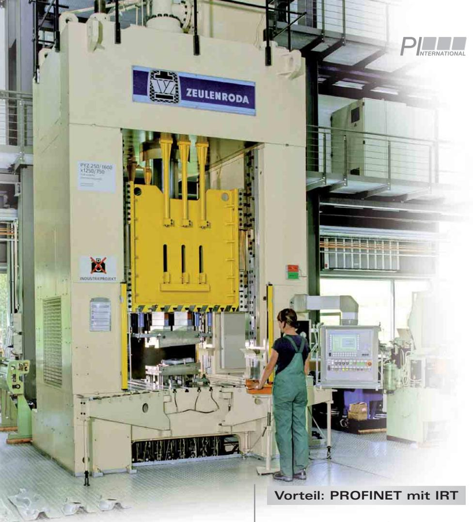
Bei dieser Presse wurde die Steuerung und die Ziehkissenregelung mit 16 hydraulischen Achsen mit PROFINET im 250 µs Takt realisiert.
