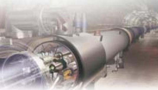
Je kleiner die Teilchen, desto größer wirken sich etwaige Ungenauigkeiten aus. Grund genug, im weltweit größten Teilchenbeschleuniger mit verlässlichen Partnern zu arbeiten. Dort halten 1382 Stellungsregler mit PROFIBUS PA-Kopplung das Kühlmittel für die supraleitenden Magnete exakt im Fluss.
