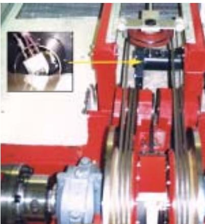
Ein Multitour-Winkelcodierer erfasst die Position während der Beschleunigungsphase.
