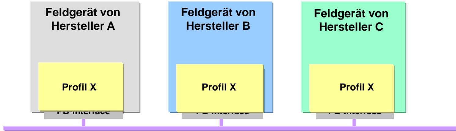
**Die Implementierung eines identischen Profils (X) in allen Geräten bewirkt ein gleichartiges Verhalten und ein reibungsloses Zusammenwirken der Geräte am Bus.**
