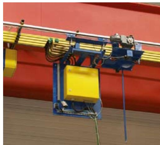
Die Safety-Signale werden berührungslos übertragen. Das pfiffige Konzept von Siemens in punkto Industrial Wireless-LAN bietet hohe Zuverlässigkeit.
